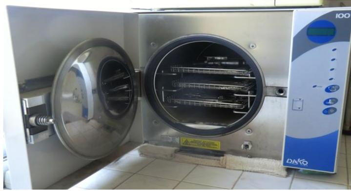
***Figure 6 : Autoclave***
