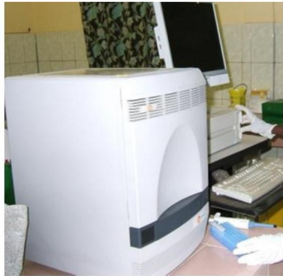
**Figure 14 : Appareil Abbott m2000sp Figure 14B : Real Time PCR m2000rt (Abbott)**
