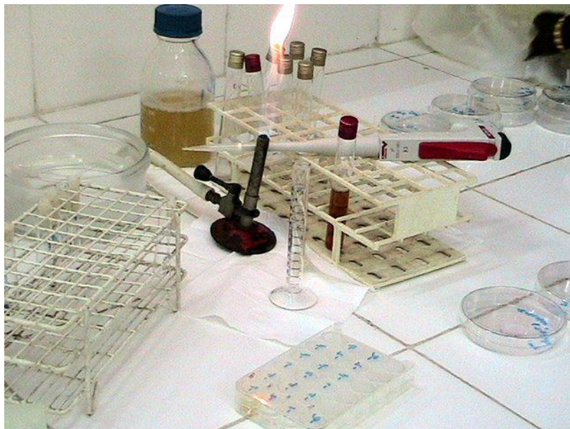
Figure 2 : Matériels et milieux nécessaires au dénombrement sur boîtes de Pétri.
